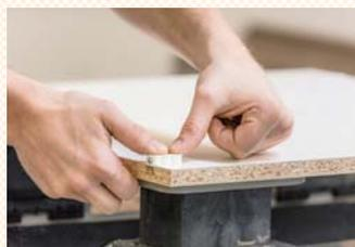
2. Montage de l'élément d'assemblage monobloc
