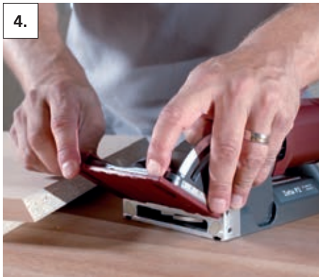
4. Placer la butée pivotante sur 60° et monter la plaque auxiliaire 4 mm
