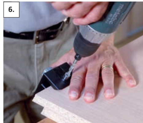
6. Percer l'orifice d'accès au Clamex P
